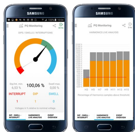
Abbildung 3 Power Quality Auswertung für Dips/Swells/Interrupts (links); Oberschwingungen (rechts)
