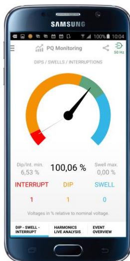
Bild: WeSense - mit intelligentem Ladeadapter und einer App wird das Smartphone zum Sensor für Netzqualität
